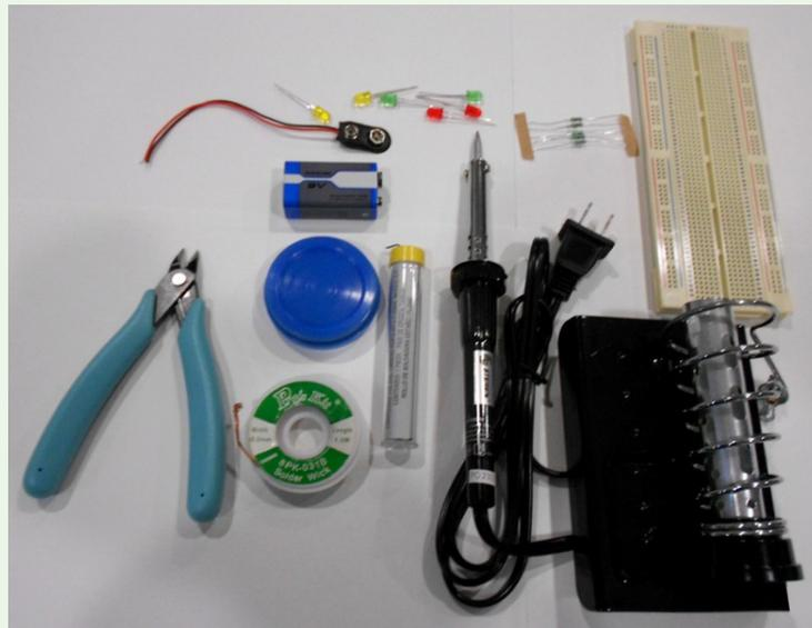
Las herramientas básicas de un aficionado a la electrónica y a la robótica deben incluir pinzas, pinzas de corte, un cautín y una tarjeta de prototipos.
